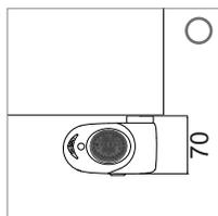
L'ingombro complessivo del radiatore in altezza va calcolato considerando l'altezza del termostato.
